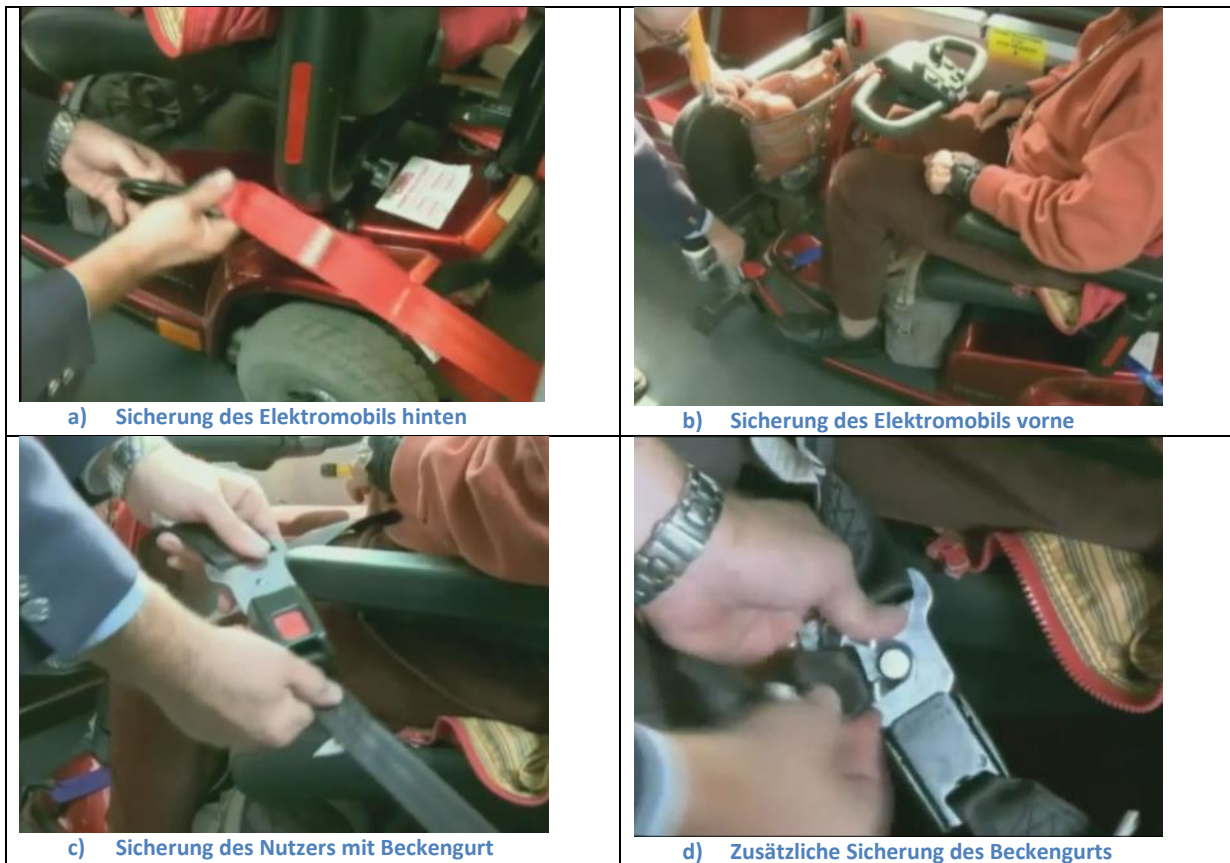
Bild 14: Sicherung eines Elektromobils und des Nutzers in einem Bus in Toronto [77]
