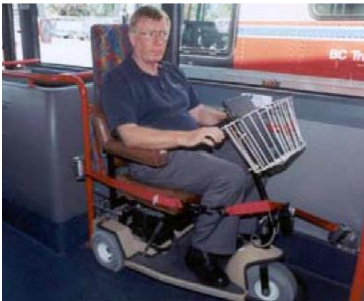
Bild 39: Einfaches Sicherungssystem mit Gurten zur Fixierung eines dreirädrigen Elektromobils in einem Linienbus bei Aufstellung entgegen der Fahrtrichtung – Beispiel Kanada [73, S. 21]
