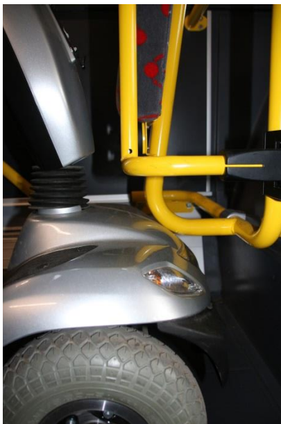
Bild 25: Berührung der vorderen Abdeckung des Elektromobils an den unteren Verbindungsstangen des Rückhaltesystems bei der Aufstellung in Fahrrichtung des Busses
