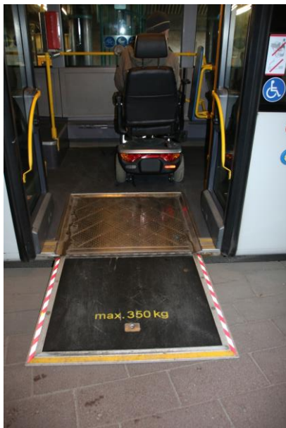
Bild 28: Manuelle Klapprampe mit einer maximalen Tragfähigkeit von 350 kg
